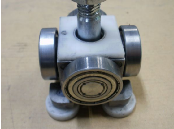
写真 - 7 試験後吊り車(1)
