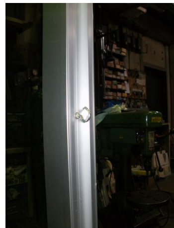
写真-6 初動力測定用フック
