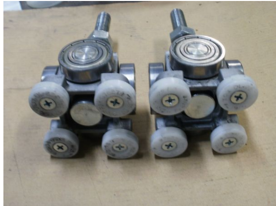
写真 - 8 試験後吊り車(2)
