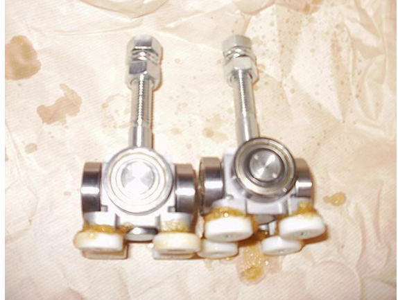
写真-2 走行テスト前吊り車(2)
