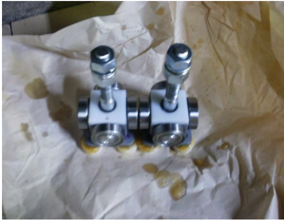
写真-1 走行テスト前吊り車(1)
