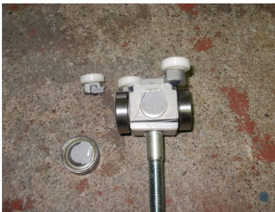
写真 - 5 引張りテスト後吊り車
