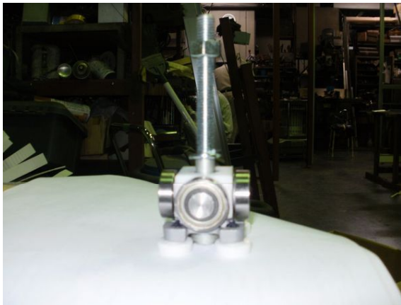
写真 - 3 引張りテスト前吊り車
