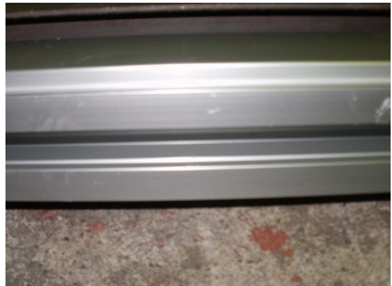
写真 - 4 引張りテスト後レール
