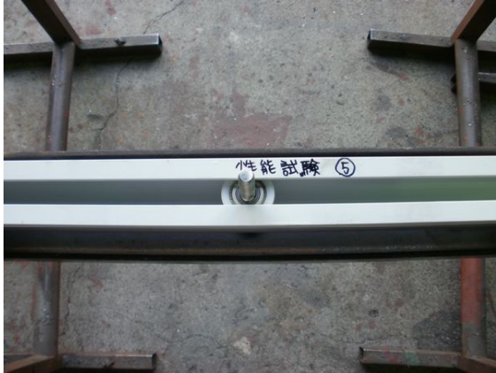
写真 - 1 引張りテスト前レール
