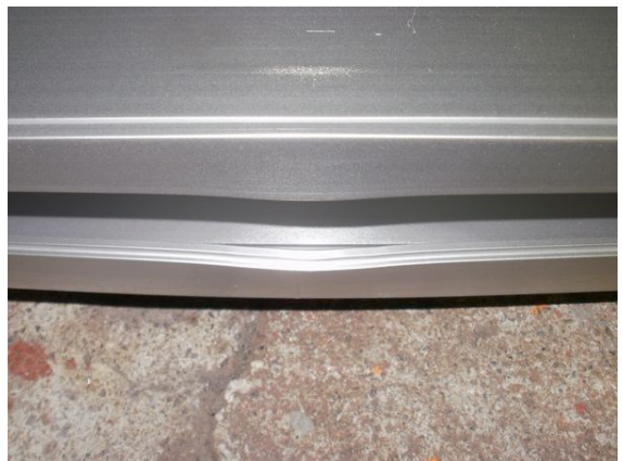
写真 - 5 引張りテスト後レール
