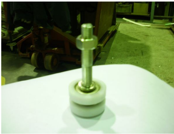
写真 - 3 引張りテスト前吊り車
